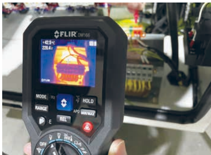
圖二 變壓器熱顯像溫度
