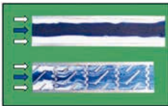
圖二、熔膠通過混合器進行混煉狀況
