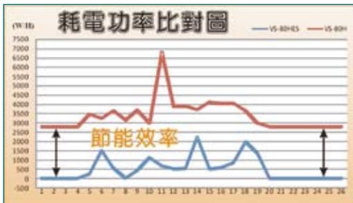
上圖耗電功率比對圖爲成形一模週期，且不含電熱的耗電功率，圖表中明顯看出，節能機在無動作時，耗電量幾乎爲0的狀態，而一般機種卻依然有約2700W/H的耗電功率。
