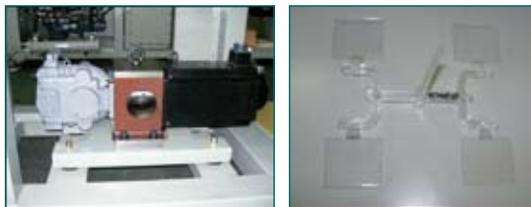
射出成型機的消耗功率，大概分爲兩個主要部分，液壓系統油泵的電力消耗以及電熱片加熱的電力消耗，此次測試，先分別量測VS-80H以及VS-80HES總耗電量，再量測液壓系統油泵耗電量，並做一比較，所得數據爲：
