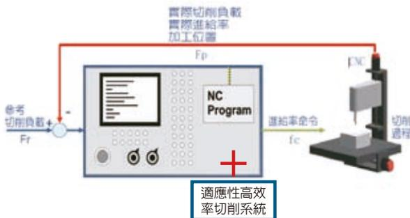
現今的CNC機台加工操作都維持一個固定不變的，由NC程預先設定好的進給率進行均速的加工，不能根據加工過程中出現的動態變化，對進給率進行彈性的調整，導致低效率，金屬切削加工過程中，眾多切削參數的選擇對加工生產率和經濟效率具有重要的影響，有時即便單個切削參數的改善也可以明顯的改善加工效果。
