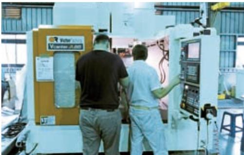
Vturn-V560搭配帝國夾頭來完成OP1及OP2 (工件正反面車加工)，及另一台Vcenter-70 搭配油壓夾治具加工OP3 (PCD 鑽孔) /OP4 (側邊28MM 孔加工)/OP5 (倒角)，不但可提高產量及幾何精度，也滿足日本高精度及CPK要求，整條線的客製化搭配起來甚至超越原有日本機的效率。
