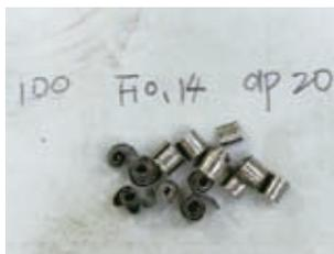
槽刀 70bar高壓刀尖出水
