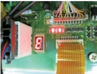
(圖一)故障LED顯示
