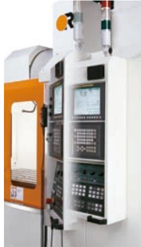
最新技術的A輪廓控制(AICC)結合FANUC 0i-MD控制器可搭配預讀單結200個，提供與機器一體化程度最佳且最高的可靠性。由經驗豐富的電控工程師以PLC開發Vcenter-A72/A85/A110/A130提供了極佳的安全性及大大地提高機械效率，來滿足產品多樣化需求。
