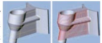
3. 平面相交工法Parallel Planes：利用工作平面產生許多平行的面與零件相交來產生刀具路徑。
