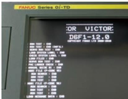
圖一 開機檢查狀態顯示
