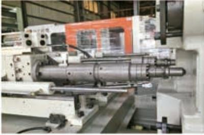
RC-220矽膠料管+油壓閉式射嘴
