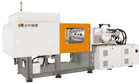
品，而在沒有產能時，仍保留各別雙射機及標準機可獨立生產的彈性系統。機台控制可透過PIS網管平台，監視整個自動化系統的狀態監視，同時透過成品影像監控系統監測成品脫落，以防止成品未完全脫模造成模具損壞，達到生產、品管無人化的自動化目標，在減化製程與智能生產上，對傳統製造商有莫大助益。展覽產品為高質感冷飲杯，可表現縮減生產製程、提高生產穩定度、大幅降低生產成本的智慧化彈性生產概念！
