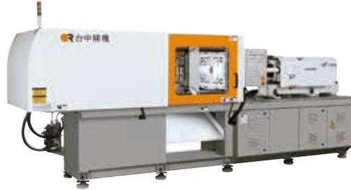
配磁性夾模系統，讓使用者實現快速、省力更換模具的期望。
