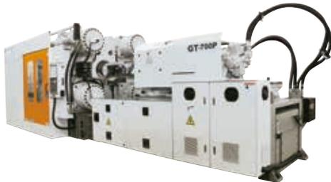
軌，有效降低鎖模二板運動阻力，特殊力集中模板結構設計，鎖模力有效集中於模具，降低模面變形，提升模板平行度與穩定性，四組直壓鎖模油缸提供平均鎖模力，模具不易型變，延長其使用壽命，開關模位置尺採用高精度非接觸式數位尺，不會產生位置飄移現象，顯示及控制更準確。此次展覽內容為塑膠椅，並結合多關節型機械手，旨在表現呈現生產設備可提供結合多段後製程的整合能力！
